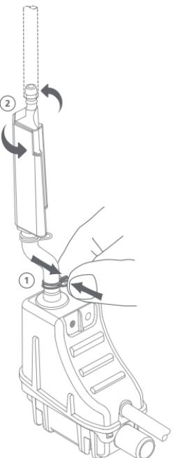
**(EN) SELECT DAMPER POSITION ENSURING THE DAMPER REMAINS IN AN UPRIGHT POSITION**
