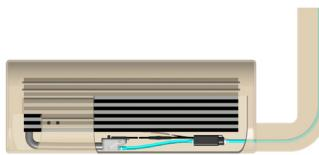
Benutzen Sie das mitgelieferte 2adrige Spannungskabel zum Anschluss der Pumpeneinheit:
