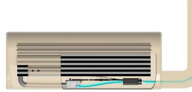
Utilizzare esclusivamente il cavo fornito a 3 conduttori:
