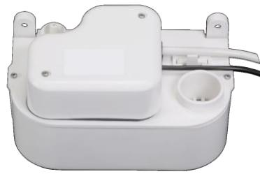
SUNNY FLOWATCH® contient une pompe et un réservoir équipé d'un flotteur. A l'arrivée des condensats dans le réservoir, la pompe se met en marche.
